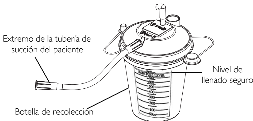
FIGURA 2 Componentes de la botella de recolección
